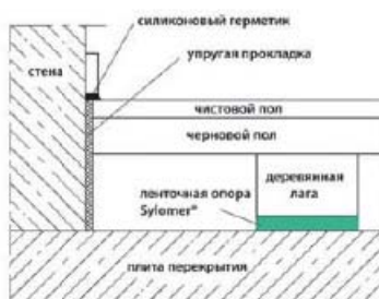
Принципиальная схема устройства «плавающего» пола на лагах
