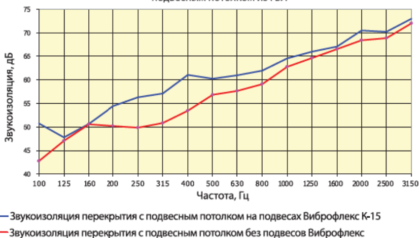
Звукоизоляция монолитного ж/б перекрытия 250 мм с подвесным потолком из ГВЛ
