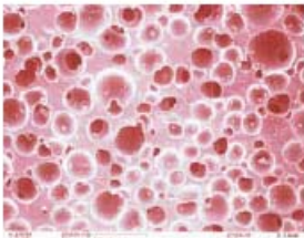
Открыто-закрытая структура ячеек материала Sylomer
