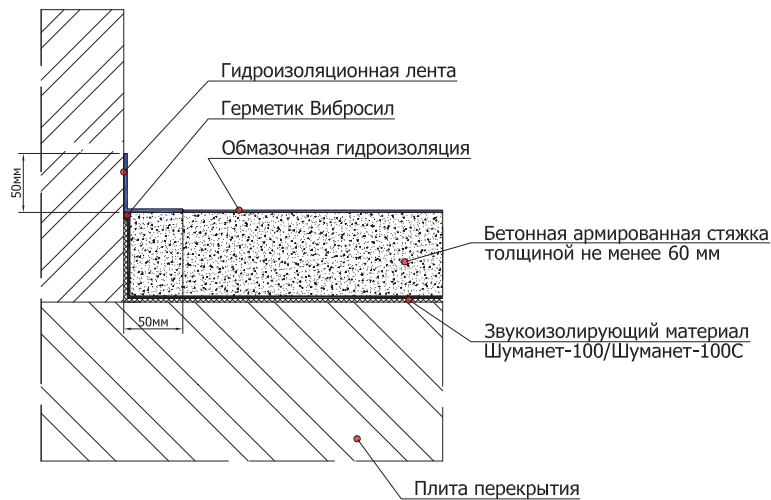
5.8.3 Схема устройства гидроизоляции в конструкции плавающего пола с применением звукоизолирующих плит Шумостоп в один слой
