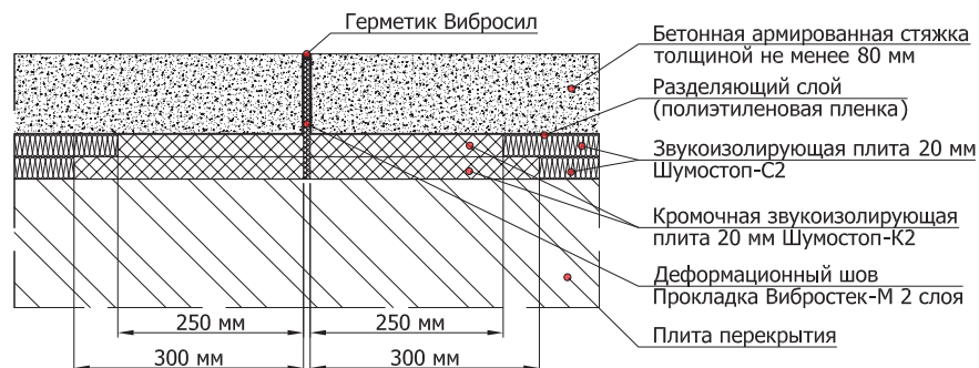
5.4.5 Схема устройства конструкции плавающего пола с применением звукоизолирующих плит Шумостоп в два слоя
