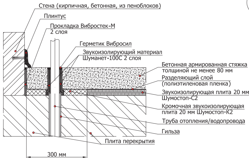
5.4.3 Схема примыкания конструкции плавающего пола с применением звукоизолирующих плит Шумостоп в один слой к стене и трубе отопления/водопровода
