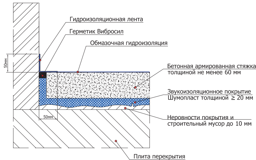
5.8.4 Схема устройства гидроизоляции в конструкции пола с применением панелей ЗИПС-ПОЛ
